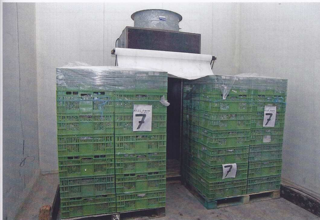
Foto 2: voorbeeld van een effectieve zelfbouw-pressure cooling, hier met twee pallets. Er kunnen eventueel twee rijen pallets worden geplaatst. De koude lucht wordt door het product getrokken en komt in de centrale gang terecht, tussen de twee (rijen) pallets in.
